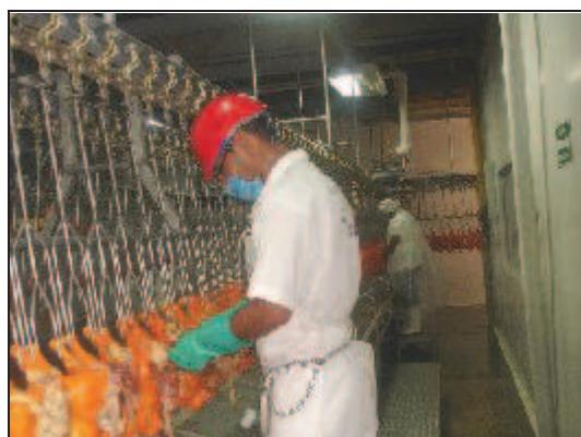
Figura 10. Eviscerado de pollos en una línea automática (Servicio Público de Rastros, Municipio León Guanajuato - México, 2007)
