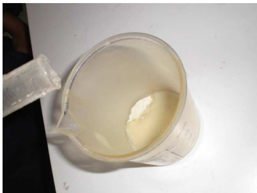
Mezcla de 5 g de muestra en polvo y 20 ml de agua destilada
