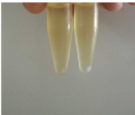
Glicoalcaloide flocculados después de la centrifugación
