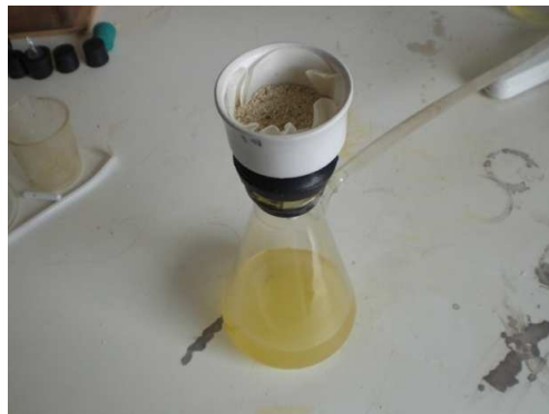
Filtración de la mezcla al vacío
