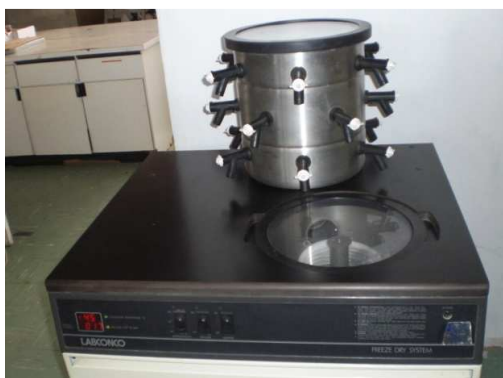
Liofilización de papas a \sim 45^{\circ}\text{C}
