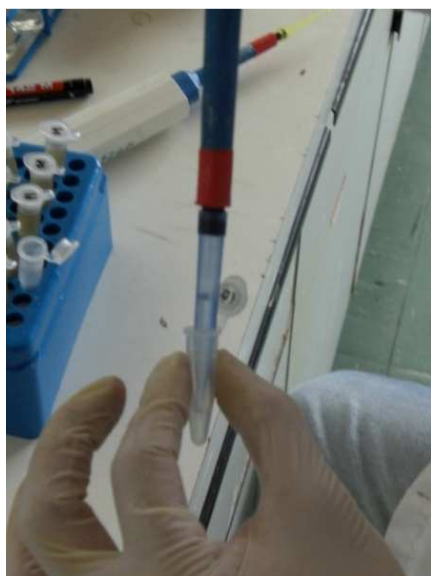
Adición de ácido ortofosfórico
