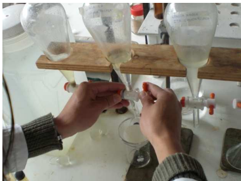
Recuperación de la fase acuosa después de ser mezclada con ácido acético y éter de petróleo en el embudo de decantación
