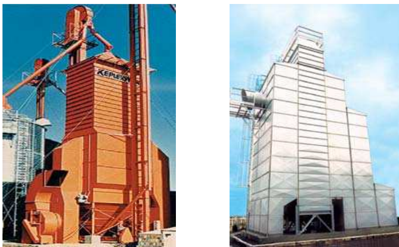
FIGURA 2.4 ESQUEMA DE UN SILO DE SECADO Y ALMACENAMIENTO DE GRANOS
