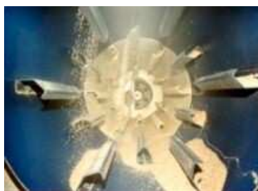
BAFLES PARA LA DISTRIBUCIÓN DEL GRANO EN FORMA DE CASCADA
