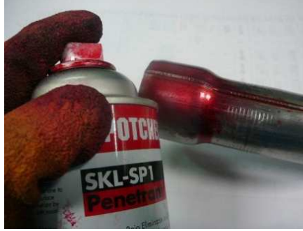
Figura 4.1 Aplicación homogénea del tinte penetrante
