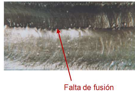
Figura 2. Fusión incompleta entre cordones de soldadura
