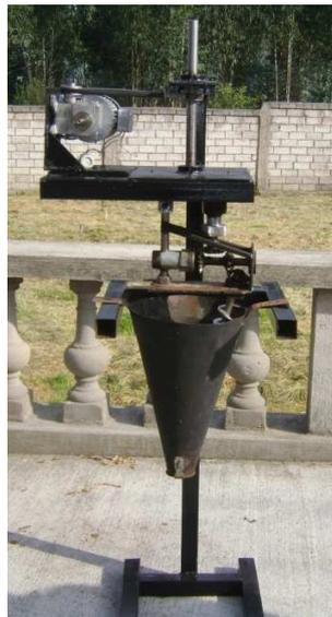
**Figura 59.** Mezclador cónico vertical
