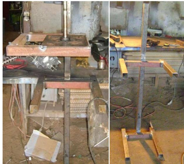
**Figura 55.** Soporte del mezclador
