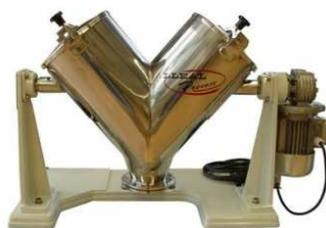
**Figura 15.** Mezclador en V
