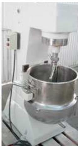
**Figura 9.** Mezclador palas planetario.
