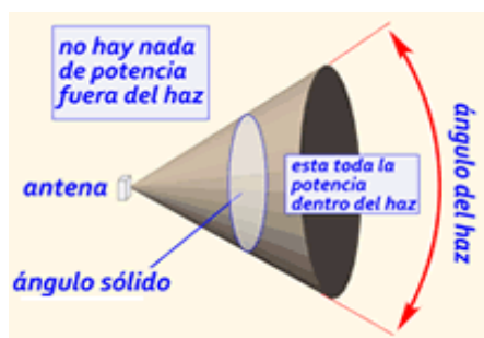
Figura 2.3 Patrón de radiación aproximado
