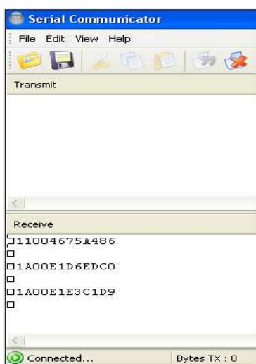
Figura 2.11 Prueba de lectura de 3 tags (Formato ASCII) del lector ID-12
