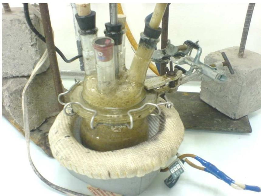
**Figura 2.3.** Hidrólisis ácida del papel en reactor tipo kettle de vidrio
