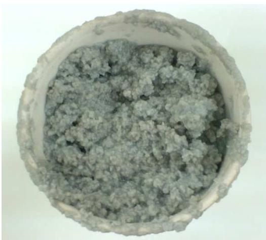
**Figura 2.2.** Pulpa de papel obtenida en una de las pruebas para determinar la mejor velocidad de agitación
