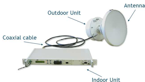
Figura 3.9: Partes del sistema microondas
