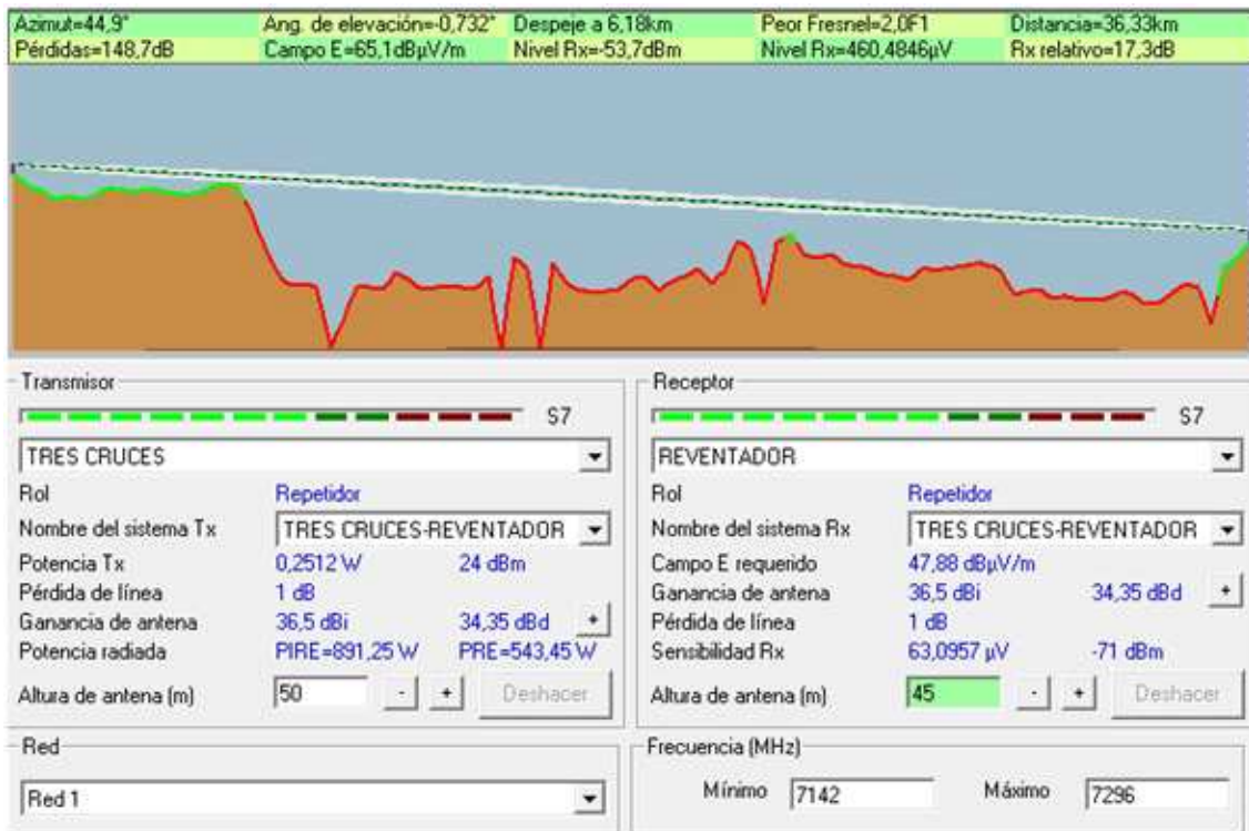
Figura 3.30: Datos obtenidos en el software Radio Mobile del enlace Tres Cruces - Reventador
