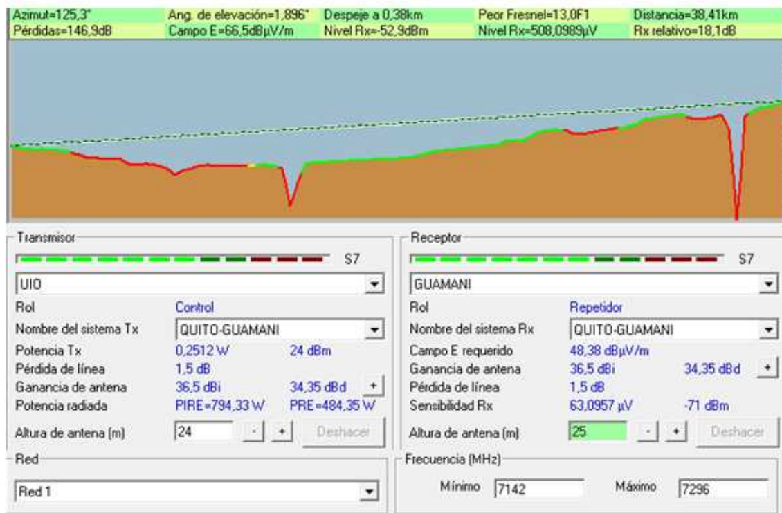
Figura 3.21: Datos obtenidos en el software Radio Mobile del enlace Quito - Guamaní
