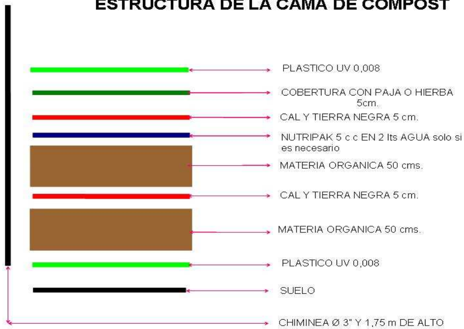
ESTRUCTURA DE LA CAMA DE COMPOST
