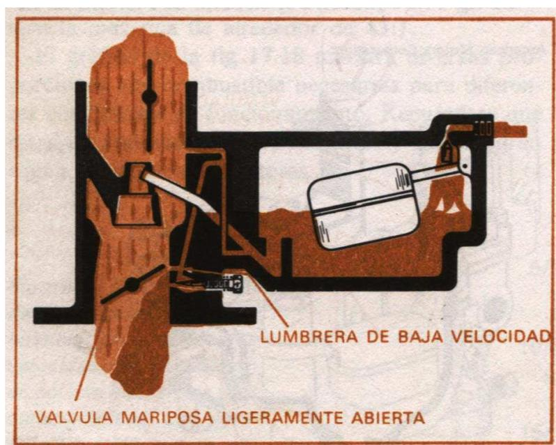
Fig. 3.3 Funcionamiento a baja velocidad.
