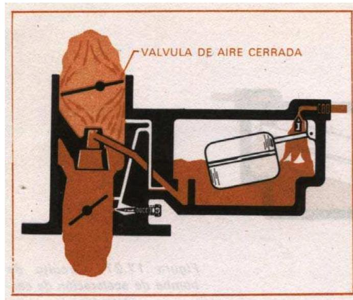
Fig. 3.7 Válvula de Aire
