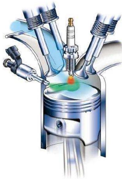
Fig. 4.1 Inyección directa de gasolina.
