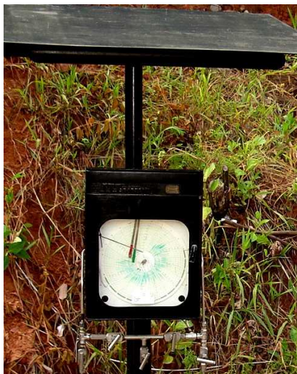
Fotografía 2.1 Registrador ITT Barton. Estación Yuca Sur 02
