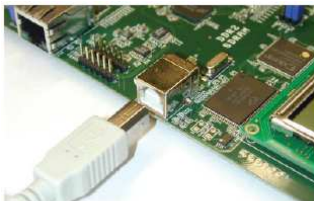
Figura 3- 5. Conexión del cable USB estándar al módulo de desarrollo
