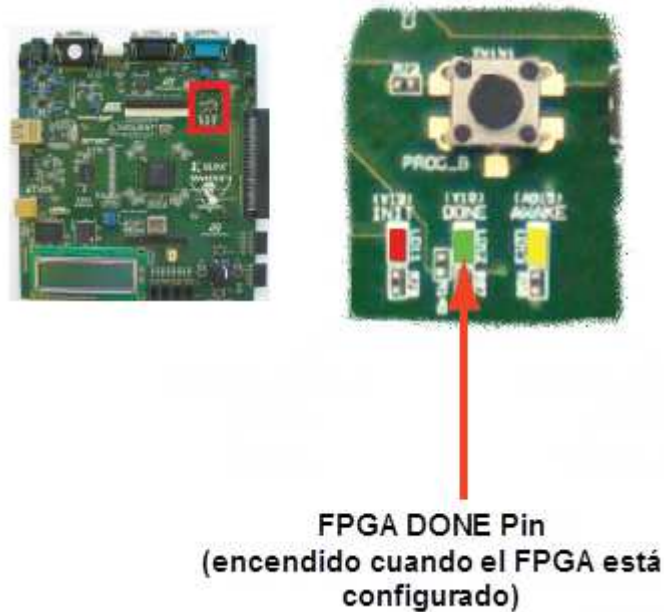
Figura 3- 7. Led de estado de configuración del módulo de desarrollo
