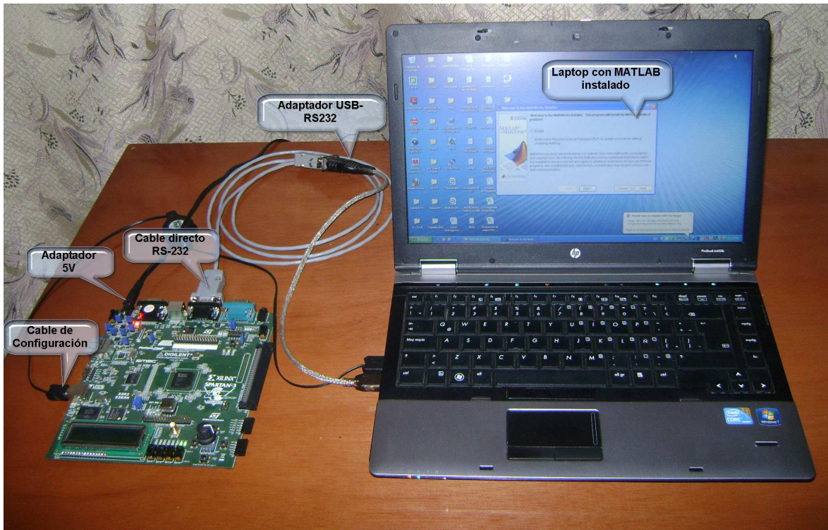
Figura 3- 9. Módulo de desarrollo conectado con una laptop
