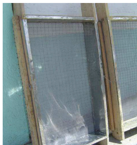
Tamices con malla y recubrimiento interior de acero inoxidable
