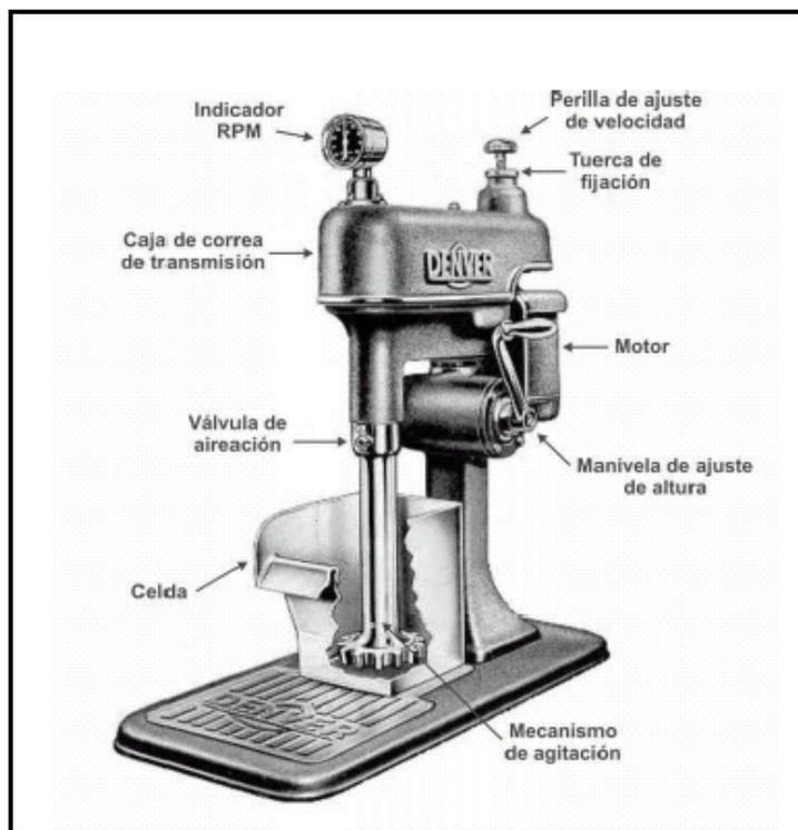
**Figura 1.5.** Celda de flotación marca Denver utilizada en laboratorios metalúrgicos (Santana, 1996)
