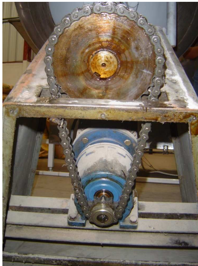
Figura 4.1: Montaje de Fuente Motriz
