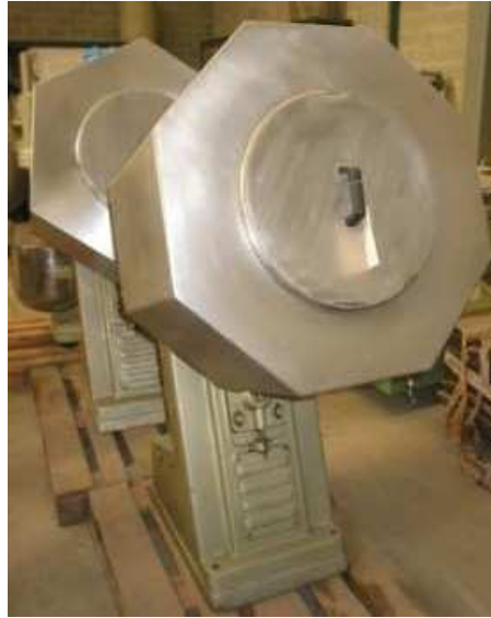
Figura 2.3. Máquina recubridora de bombo hexagonal
