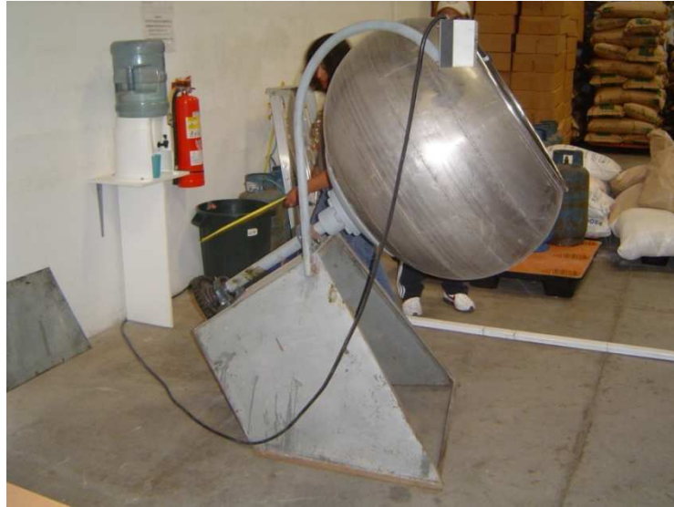
Figura 4.7 Prototipo inicial de máquina recubridora polifuncional.
