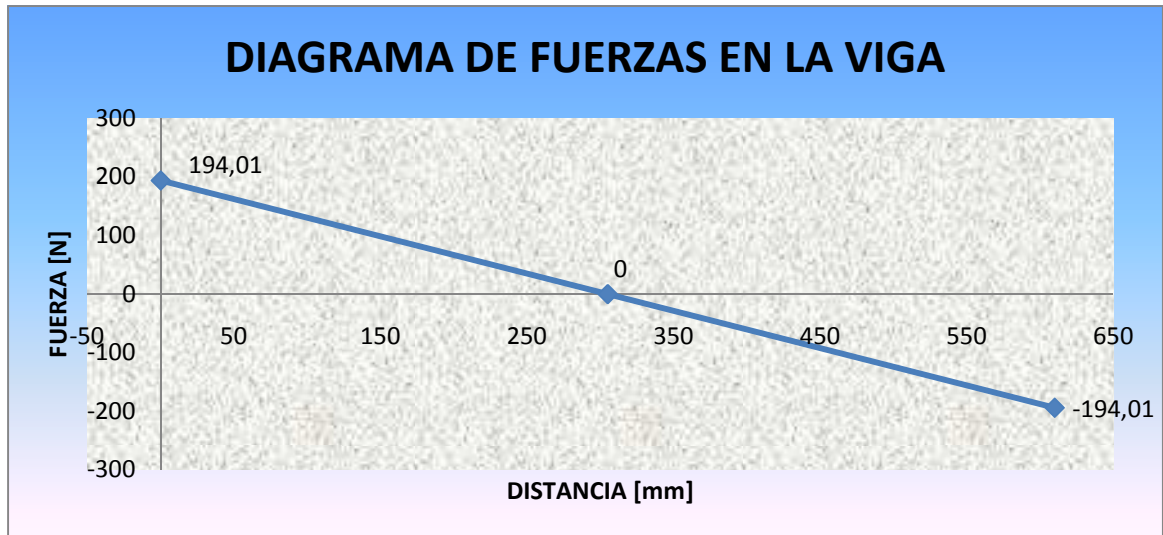
Figura 3.9: Diagrama de Fuerzas en la Viga.
