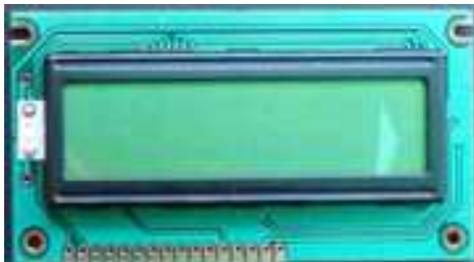
**Figura 1. 20 Display lcd de texto de 16x2 con controlador hd44780.**
