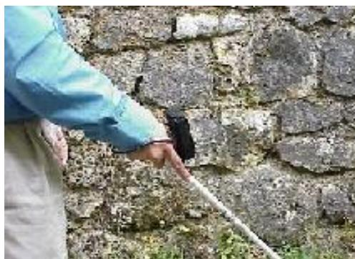
Figura 1. 5 Bastón electrónico para ciegos
