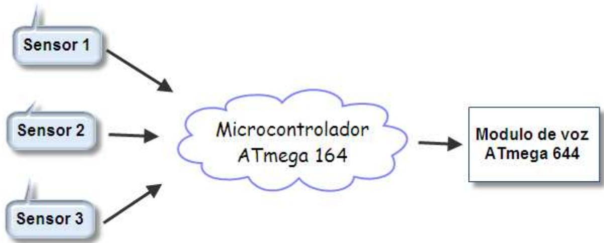
Figura 2. 2 Diagrama de bloques del bastón electrónico.
