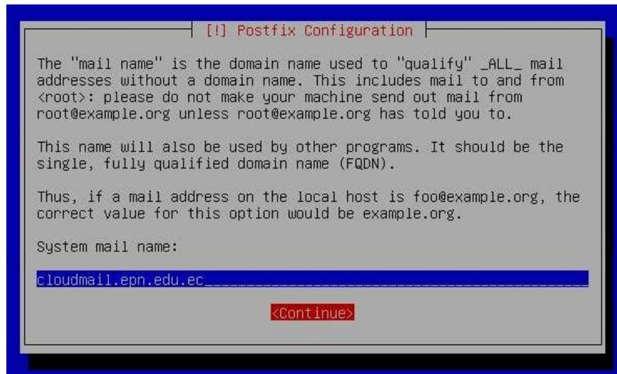
**Figura 2.19 Configuración del FQDN para el correo electrónico**
