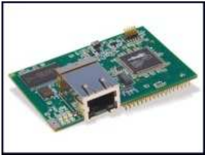
Figura 2.4 Módulo para telemetría vía Internet. 4
