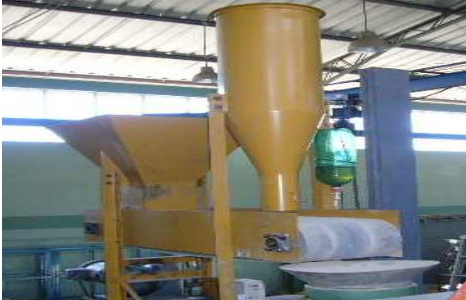
FIGURA 2.3 Tolva de alimentación y banda transportadora
