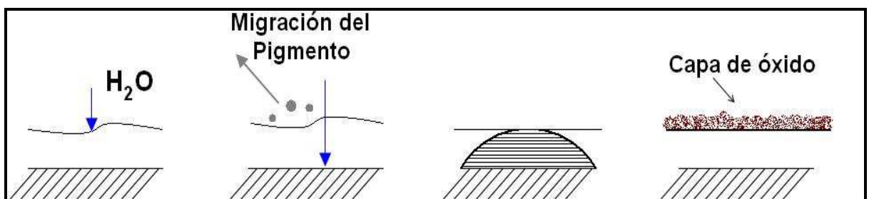
Figura 5.8: Mecanismo de corrosión en los revestimientos poliméricos
