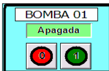
Figura 2.28 Ventana de funcionamiento ON/OFF de bomba
