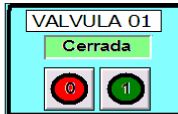
Figura 2.27 Ventana secundaria de funcionamiento ON/OFF de válvula
