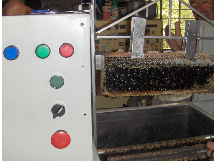
Figura 4.3 Panel recolector de miel de abejas después de la limpieza de cera.
