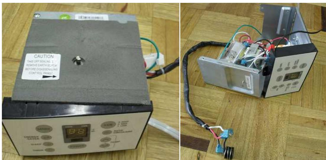
**Fotografía No. 3. 8 Control utilizado en el equipo de aire acondicionado**
