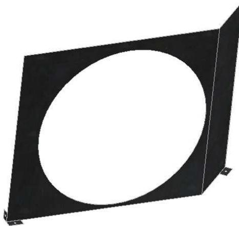
**Figura No. 4. 44 Separador de ambiente del condensador<sup>1</sup>**
