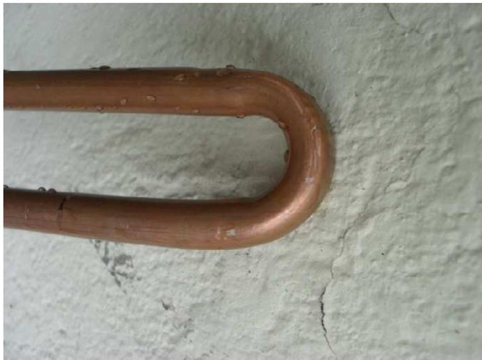
**Fotografía No. 4. 10 Resultado del doblado con hielo en tubos de 3/8''**
