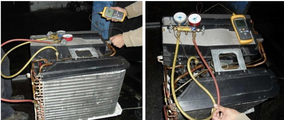
Fotografía No. 2. 1 Medición de temperaturas, presiones, velocidad del aire y humedad relativa
