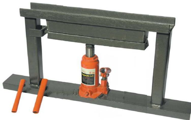
Figura No. 4. 37 Dobladora de láminas
