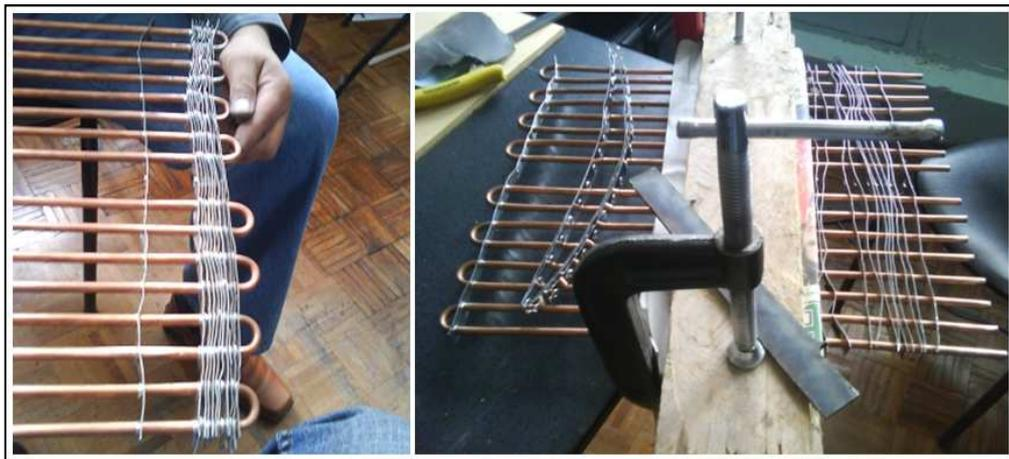
**Fotografía No. 4. 16 Construcción artesanal del panel recto del condensador**
