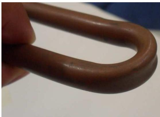
**Fotografía No. 4. 7 Deformación plástica en tuberías de cobre de 3/8''**
