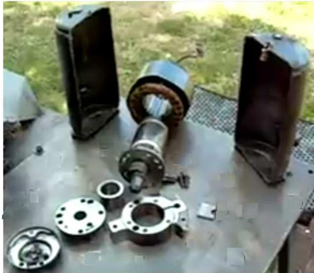
Fotografía No. 3. 2 Partes de un compresor rotatorio de pistón rodantes
