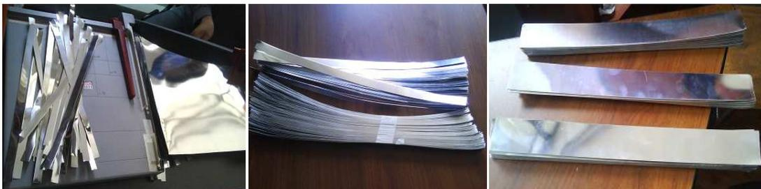
**Fotografía No. 4. 13 Segundo corte de la lámina de aluminio**
