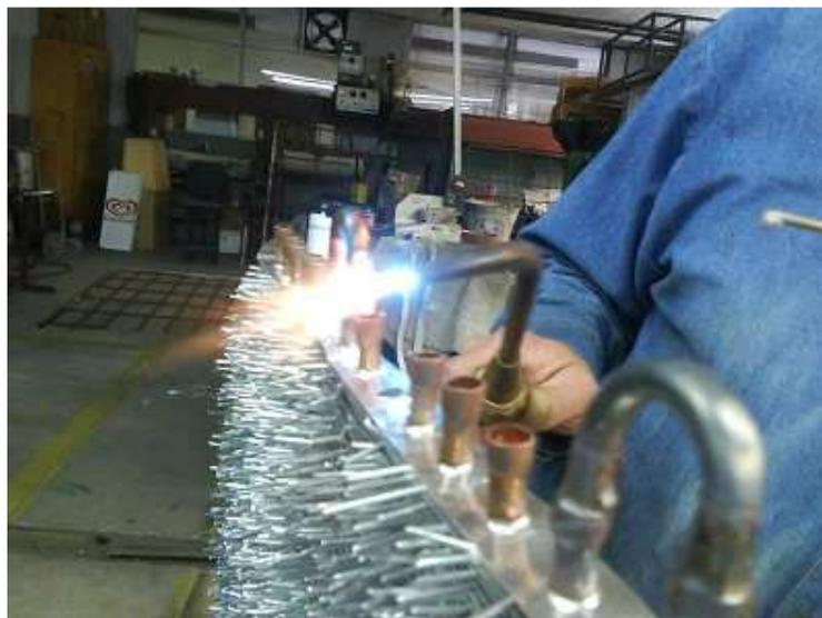
**Fotografía No. 4. 21 Soldadura de codos**
