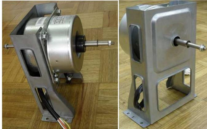
**Fotografía No. 3. 5 Soporte para anclaje del motor**
