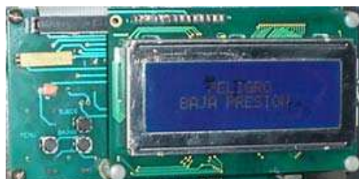
Figura 4.6 Prueba de baja presión
