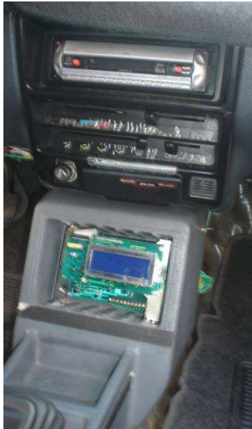
Figura 4.2 Ubicación de tarjetas del Li – Board
