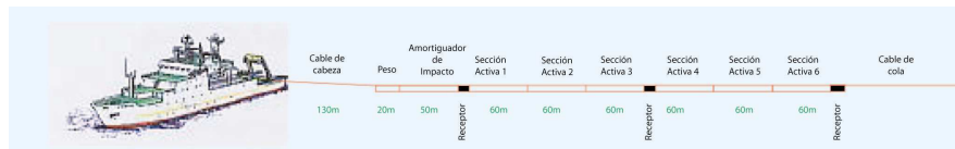
Figura 3.7: configuración del receptor analógico utilizado para la recolección de Los datos de sismica de reflexión de la campaña Amadeus.
