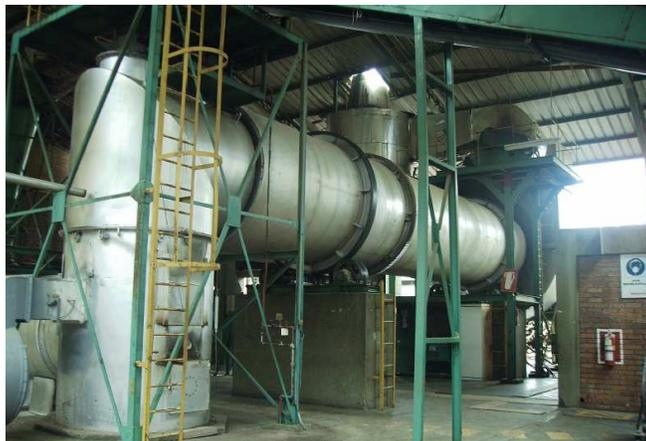
**Figura 1.5 Secadero donde se elimina la humedad de la madera**
