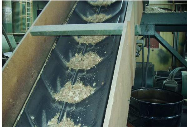
**Figura 1.4 Banda transportadora que lleva las virutas de madera hacia el tambor de secado.**
