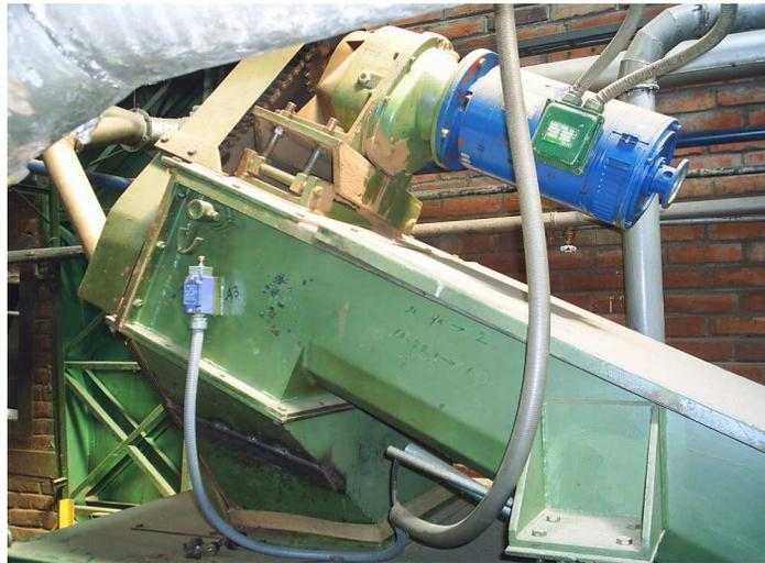
Figura 2.1 Vista del motor, reductor y grupo tornillos sin fin dosificadores
