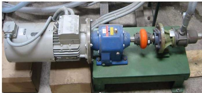
Figura 2.14 Vista nuevo motor, reductor de velocidad y bomba
