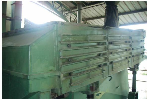
Figura 1.6 Tamiz vibratorio que sirve para clasificar el material.
