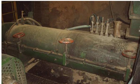
**Figura 1.7 Encoladora** donde se mezcla el material y la mezcla preparada en el encolado.
