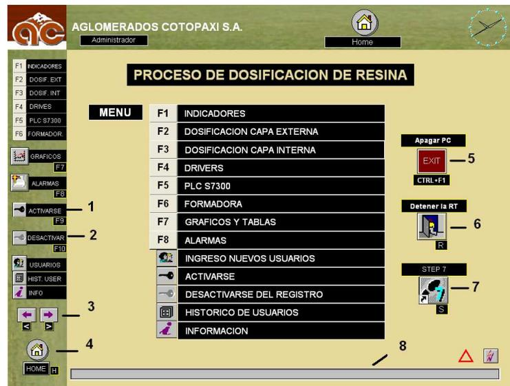
Figura 4.20 Pantalla de menú del proceso de dosificación de la resina.
