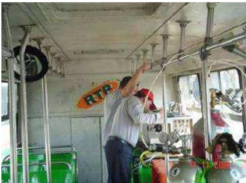
*Figura AB – 3. Instalación de un dispositivo postcombustión – proyecto Retrofit México.*
