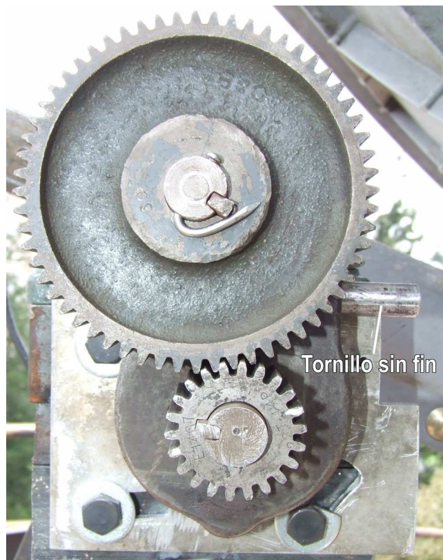
Fig. 3-7 Acoplamiento mecánico para el sistema de seguimiento
