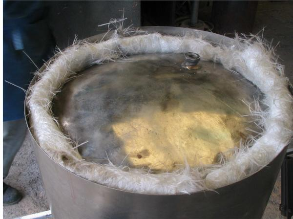
**7.- Vista del biodigestor con el forro de tol negro.**
