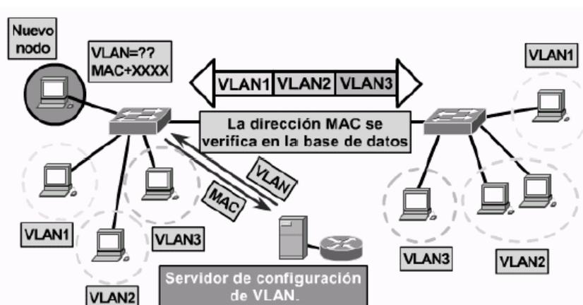
Figura 1.3: Configuración de VLANs Dinámica “3”
