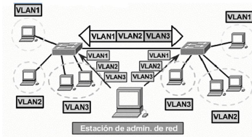
Figura 1.2: Configuración de VLANs Estáticas “3”
