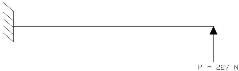
Figura 3.17: Guía sometida a esfuerzos de flexión
