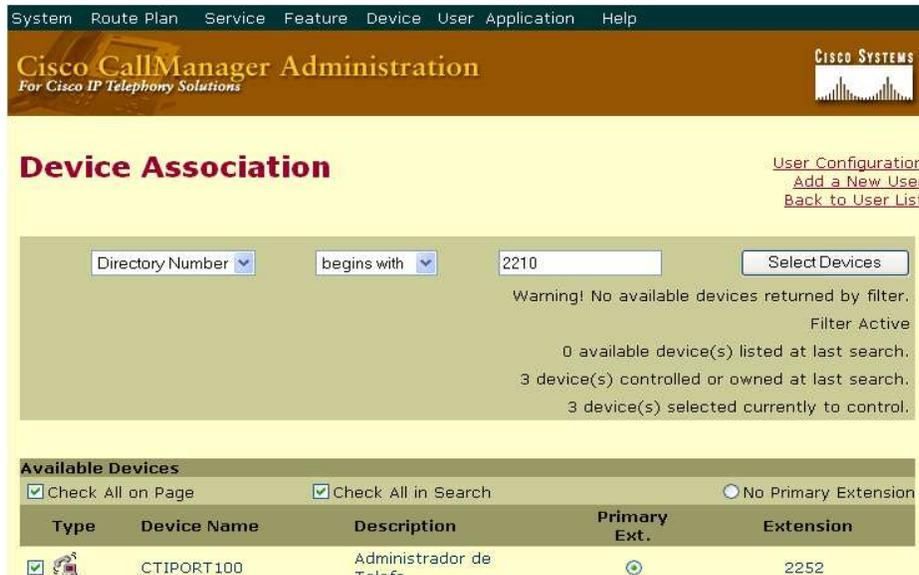
Figura 5.2.4.e Pantalla de asociación del usuario con el teléfono
