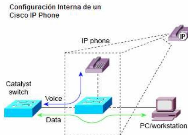
**Figura 3.2.3.b** Conexión de IP phone a la estación de trabajo
