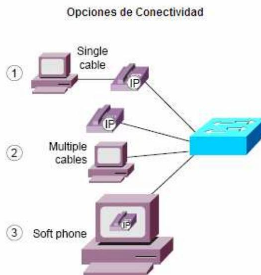
**Figura 3.2.5.a** Conexión de equipos terminales a la red
