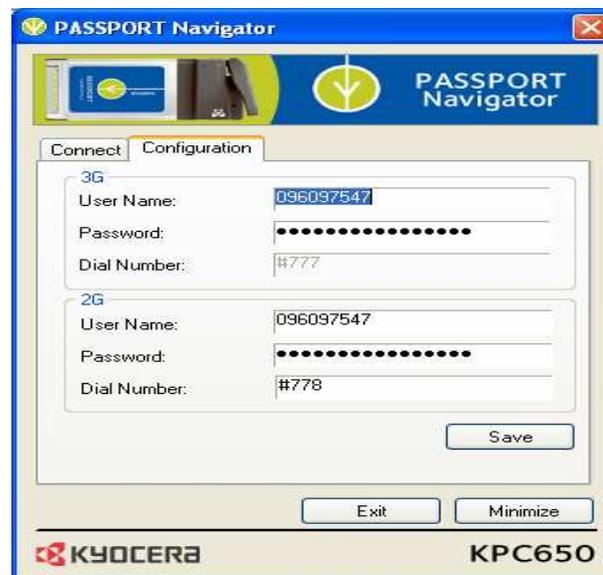
**Figura 5.2.1.2.a** Pantalla de Configuración de la tarjeta EVDO
