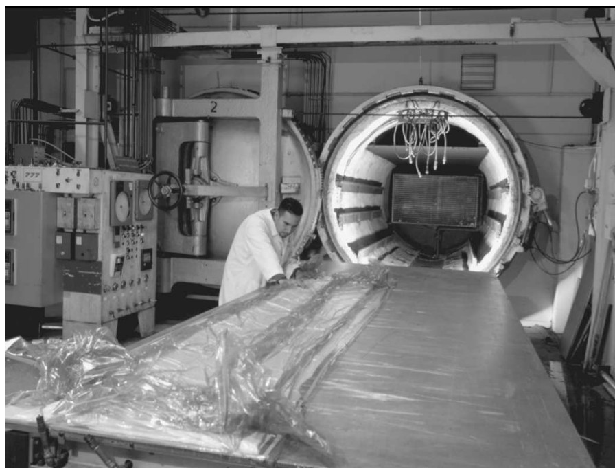
Figura 2.9. Empaque al vacío de preimpregnados que se introducen a un autoclave [Cogswell, 1992].
