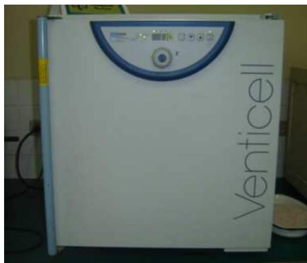
Figura 3.2. Estufa con circulación de aire marca Venticell.
