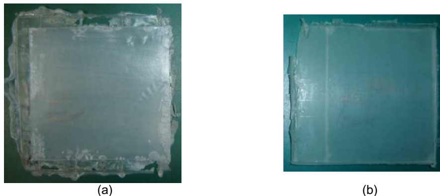
Figura 4.1. Rebabas de PP que se obtienen utilizando: (a) moldes tipo plancha, (b) molde tipo macho - hembra.
