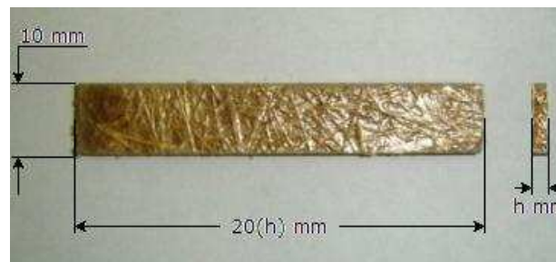
Figura 3.24. Dimensiones de las probetas para ensayo de flexión.
