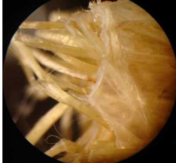
Figura 4.19. Sección transversal de la fractura que ilustra la mala inclusión del PP en la fibra de abacá.
