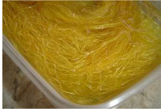
Figura 4.57. Coloración amarillenta que obtiene la fibra por cambios en su composición química.
