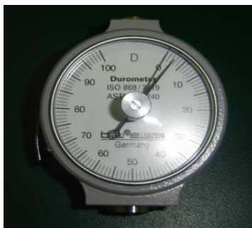
Figura 3.8. Durómetro Shore D marca Bareiss.
