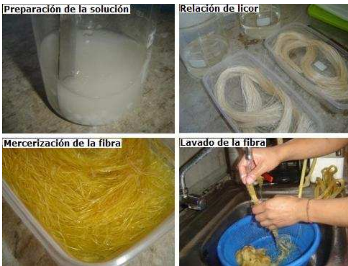
Figura 3.3. Proceso de mercerización de la fibra de abacá.
