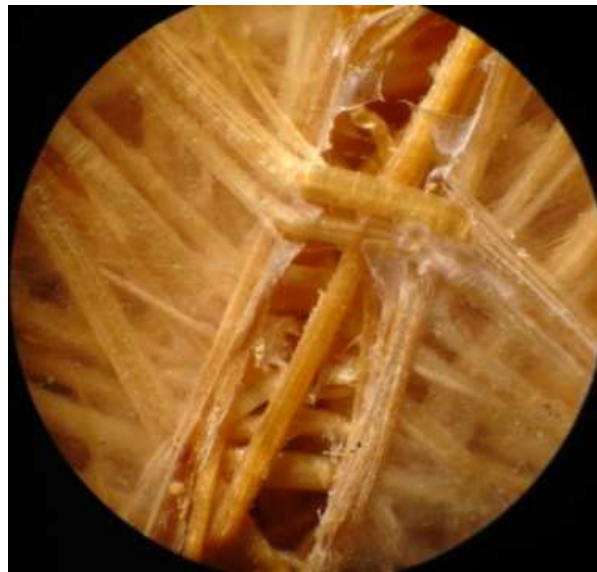
Figura 4.20. Fractura común de las probetas con fibra orientada al azar que muestra que las fibras de orientación transversal estarían actuando como concentradores de esfuerzos.
