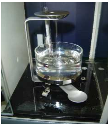
Figura 3.9. Sistema de balanza de plato suspendido para determinación de densidades de sólidos.
