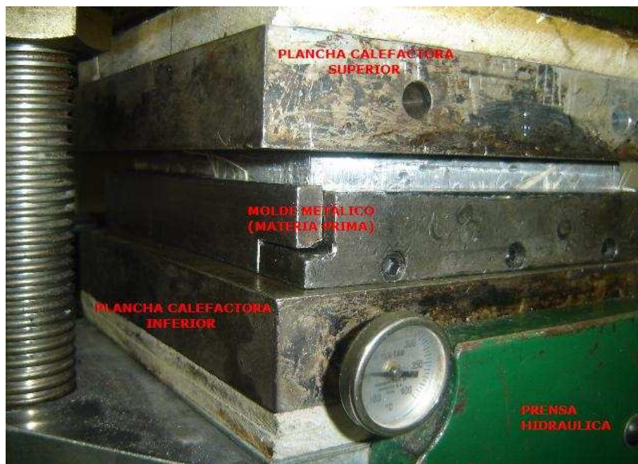
Figura 2.10. Equipo para el moldeo por compresión (técnica de prensado en caliente).
