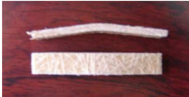
Figura 4.27. Deformación plástica en probetas de ensayo a flexión de compuestos de fibra corta.
