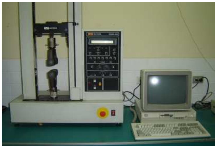
Figura 3.4. Máquina de Ensayos Universal Instron en conjunto con su sistema computarizado de control.
