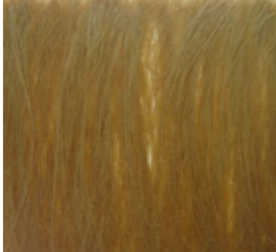
Figura 4.32. Dispersión de las fibras en los compuestos con 35% en masa de fibra continua.
