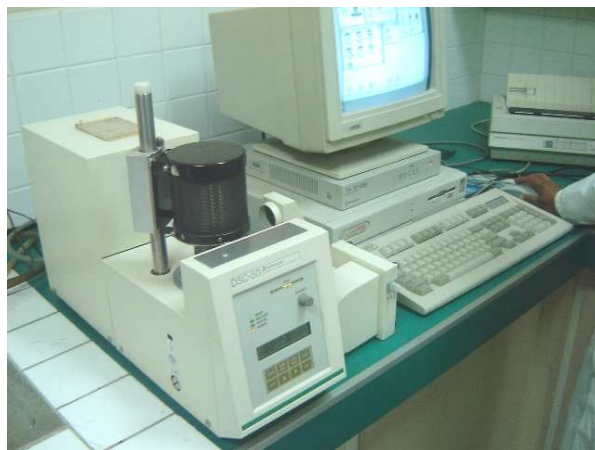
Figura 3.7. Calorímetro diferencial de barrido (DSC).
