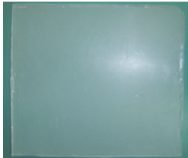
Figura 4.13. Placa de PP obtenida mediante moldeo por compresión.
