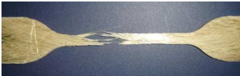
Figura 4.33. Fractura de las probetas de tracción para compuestos de fibra continua.
