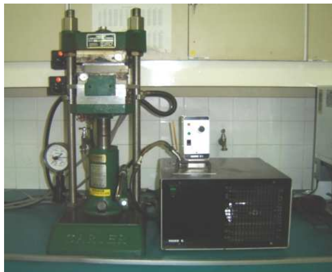
Figura 3.11. Prensa calefactora y baño térmico como sistema de enfriamiento.
