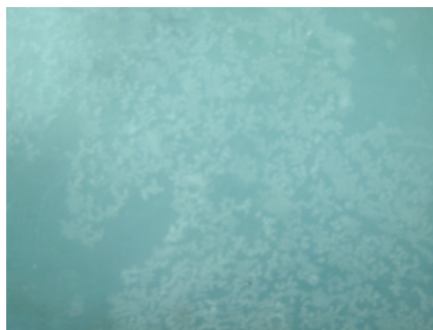
Figura 4.2. Presencia de pequeñas burbujas en las placas de PP.
