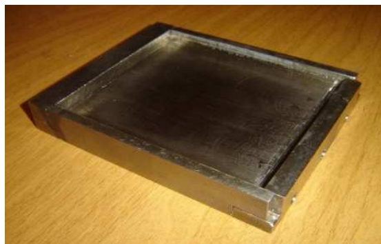
Figura 3.12. Molde tipo macho-hembra utilizado en el moldeo por compresión.
