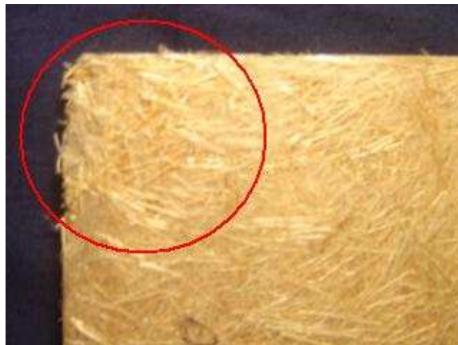
Figura 4.16. Evidencia de la saturación de refuerzo en los compuestos con 35% de fibra.
