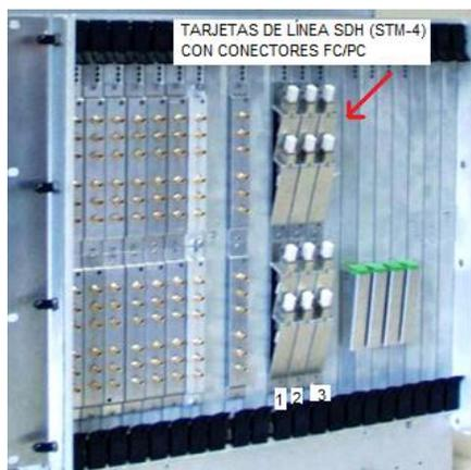
Fig. 18 Interfaces del multiplexor SMA 16
