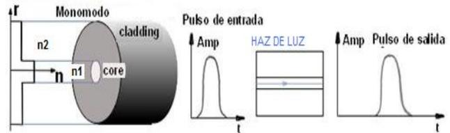
Fig. 9 Características de transmisión en la fibra óptica monomodo
