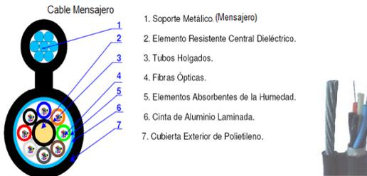
Fig. 12 Estructura del cable óptico Figura 8
