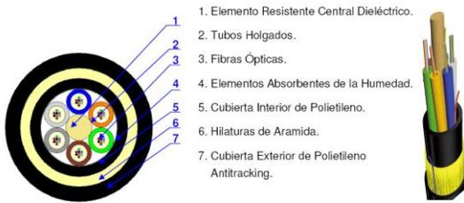
Fig. 11 Estructura del cable óptico ADSS
