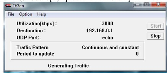
Fig.21 Utilización del programa TFGEN, IP de destino (192.168.0.1) y velocidad de transmisión 3000 Kbps
