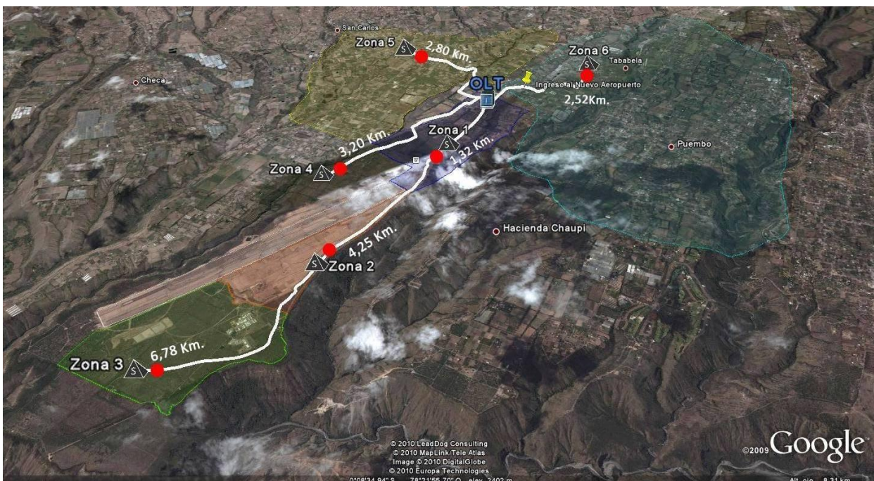
Fig. 8. Trayecto de fibra óptica, distancias y ubicación de equipos [*].
