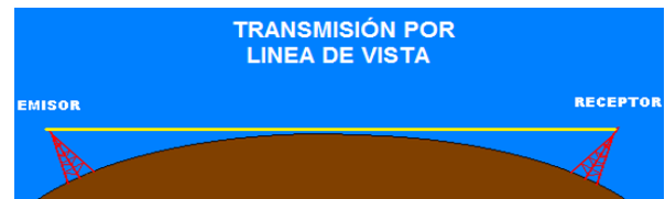
Fig. 3. Transmisión de ondas electromagnéticas por línea de vista.
