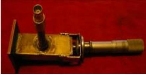
Figura 14: Circuito guía de onda rectangular con acoplamiento coaxial de alimentación.
