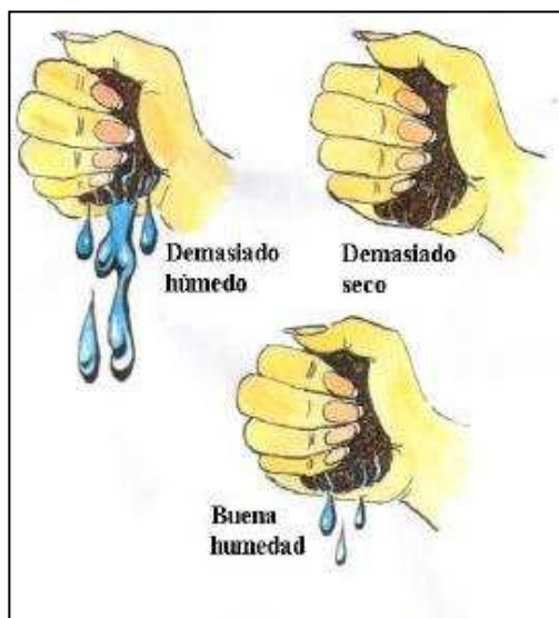
Figura 26. Medición de la humedad
