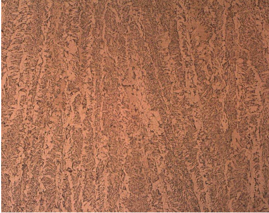
Figura 4.12.- Microestructura del cordón de soldadura SAW 100X.
