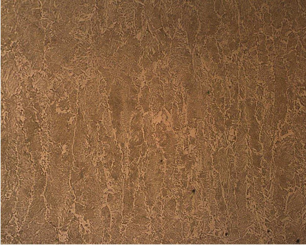
Figura 4.10.- Microestructura del cordón de soldadura SMAW E6011 a 100X.
