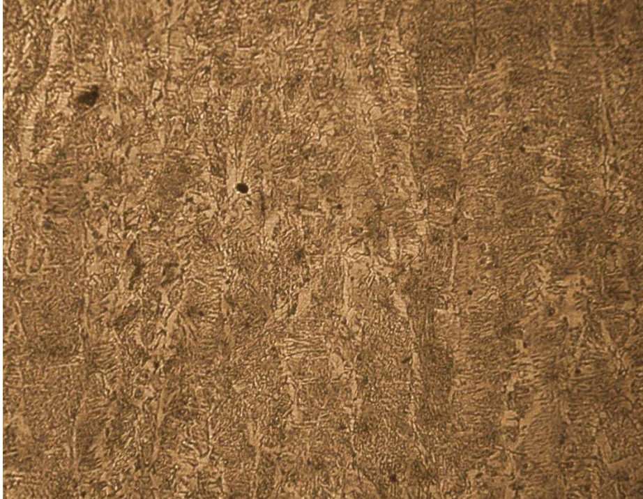
Figura 4.11.- Microestructura del cordón de soldadura GMAW a 100X.
