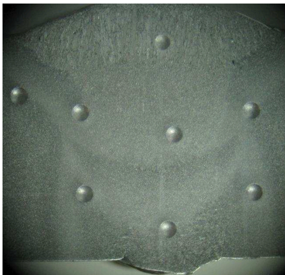
Figura 4.37.- Medidas de durezas tomadas en la soldadura y zona afectada por el calor
