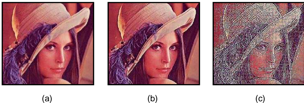
Figura 1.11. Perfilado de una imagen (a) imagen inicial (b) imagen perfilada una vez (c) imagen sometida a un excesivo perfilado
