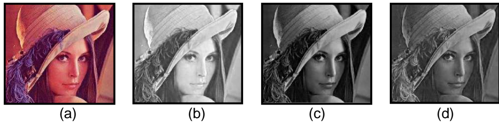
Figura 5.1. Imagen en modelo RGB y sus componentes (a) imagen original (b) canal R (c) canal G (d) canal B.
