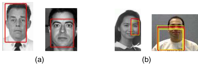
Figura 11.5. Segunda prueba realizada para la detección de rostros mediante la transformada de Hough
