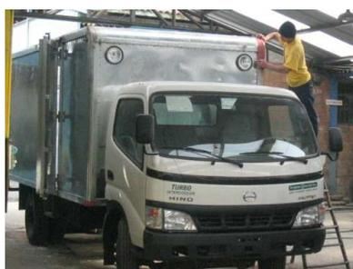
DÍA 22.- Pintura: entre 2 operarios pintan furgón, después del secado 1 operario de la sección de Acabados coloca triángulos, reflectores y placa publicitaria de ESMETAL S.A.
