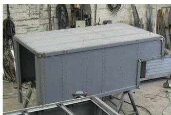
DÍA 7.- 3 operarios de la sección de Ensamblaje (Montaje) remachan los forros. Se pinta además parte delantera de caseta.
