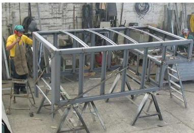
DÍA 6.- Ensamblaje (Montaje): 2 operarios continúan ensamblando la estructura de caseta e inician la colocación de forros. Arriba camioneta para montaje.
