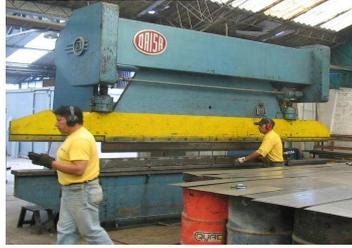
DÍA 2.- Maquinado: 2 operarios realizan corte y plegado de planchas para conformar vigas, luego 1 operario las lava y fondea.
