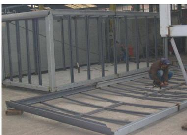
DÍA 11.- Ensamblaje: colocación de techo y refuerzos con postes, y armado de estructura de furgón efectuado por 2 operarios. A la par 2 operarios de Maquinado cortan y doblan piezas para puertas, que posteriormente son Lavadas y Fondeadas por 1 operario.
