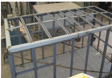
DÍA 12.- Ensamblaje: refuerzan estructura de furgón y armado puerta lateral y posteriores por 2 operarios. A la vez 2 operarios de Maquinado prepara forros de furgón que luego pasan a lavado y fondeo, actividad ejecutada por 1 operario.
