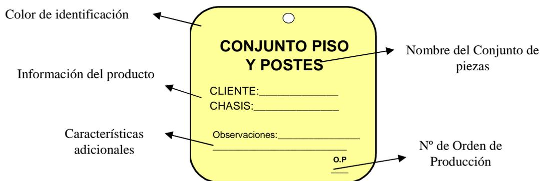
**FIGURA 4.5:** Tarjeta Kanban Tipo 1
