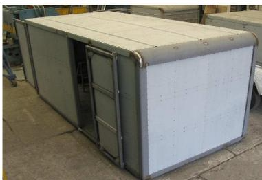
DÍA 18.- Ensamblaje: 3 operarios remachan forros. A la par en la sección de Montaje 2 operarios colocan vigas en chasis, para lo cual el vehículo arribó el día 14.
