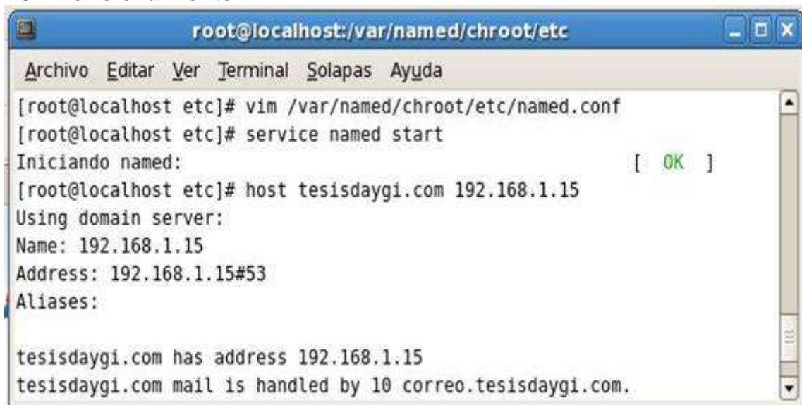
Figura 4-14 Funcionamiento Servidor DNS
