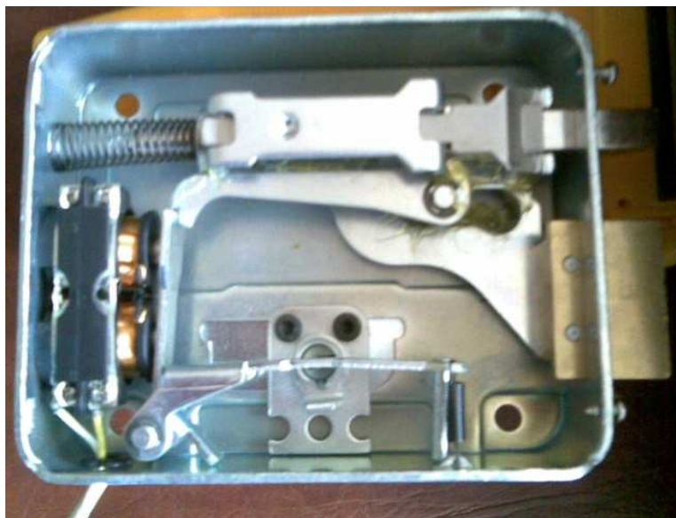
Figura 2.30: Vista interior de la cerradura eléctrica.
