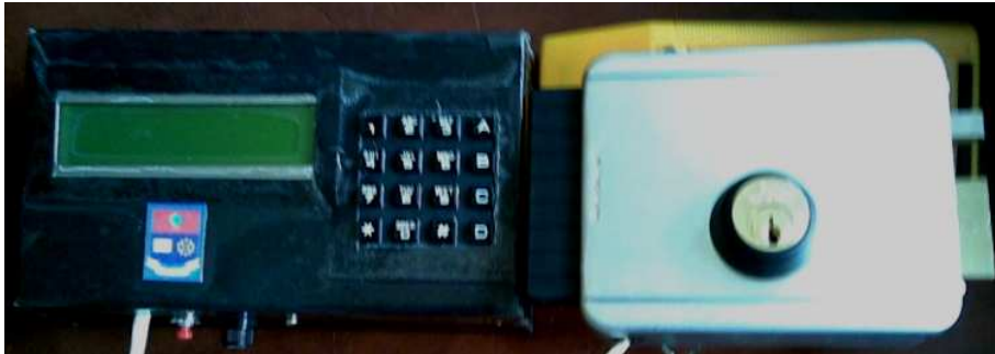
Figura 2.28: Equipo con la cerradura eléctrica.
