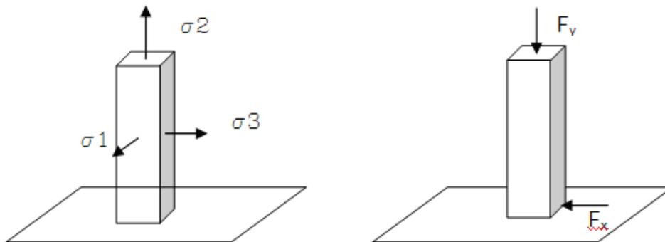
**Figura 2.29.-** Diagrama de fuerzas actuantes en un cordón de soldadura.
