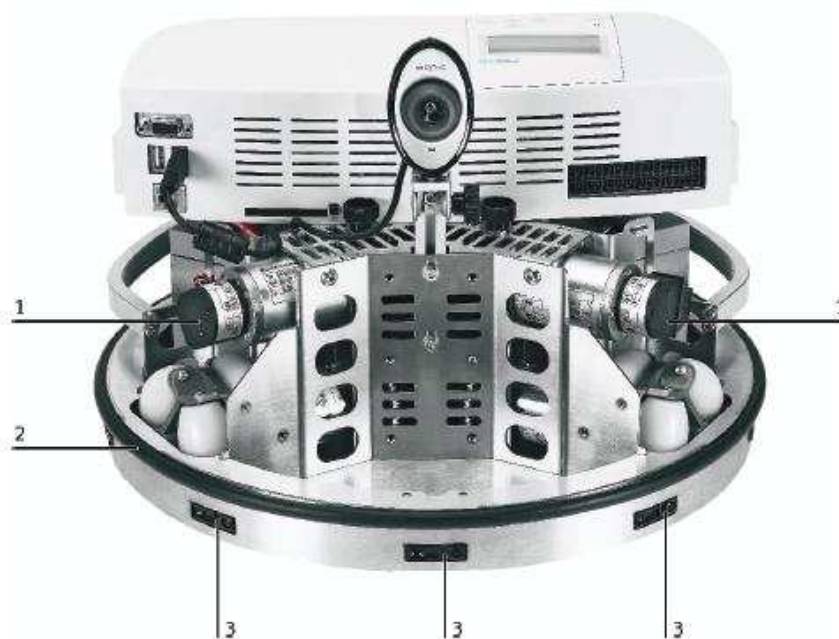
Figura 1.12 Encoder incremental (1), Banda de impacto, sensor aticolisión (2), Sensores de medición de distancia (3), tomado de [11]
