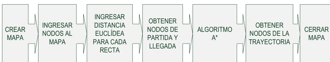
Figura 2.27 Diagrama de programación para la generación de la trayectoria
