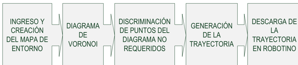
Figura 2.12 Diagrama de bloques de la programación
