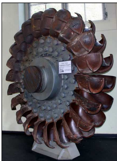
Figura 2. 27. Turbina Pelton central hidroeléctrica de Walchensee en Alemania
