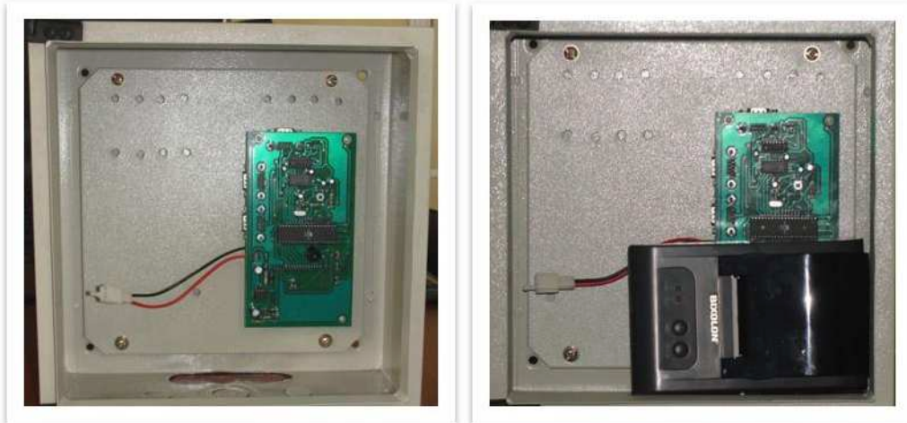
Figura 3. 21 Montaje del PCB y la impresora.
