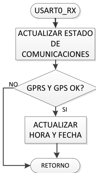
Figura 3. 12 Subrutina de interrupción para la recepción del USART0
