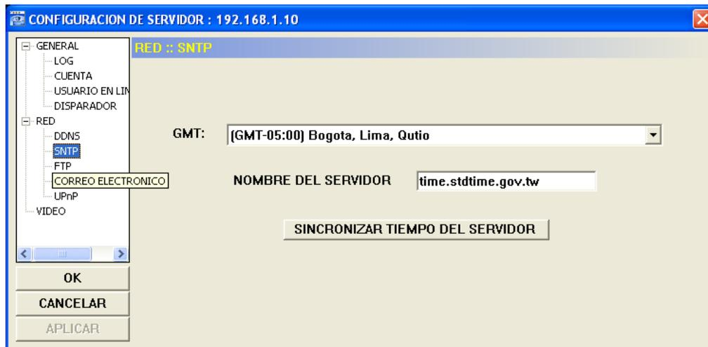
**Figura 4.15.-** Configuración de uso horario de la cámara IP.
