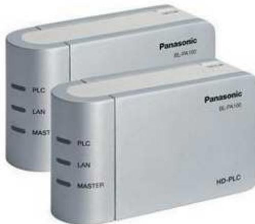
**Figura 2.16.-** Adaptador PLC <sup>34</sup>
