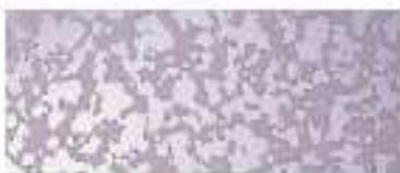
La profundidad del grabado se controla mediante el tiempo en que el acero inoxidable está expuesto al ácido.
