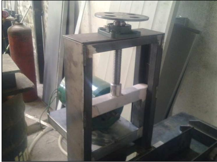
FOTOGRAFIA 3. Montaje del sistema de impulsión de la rueda abrasiva del prototipo.
