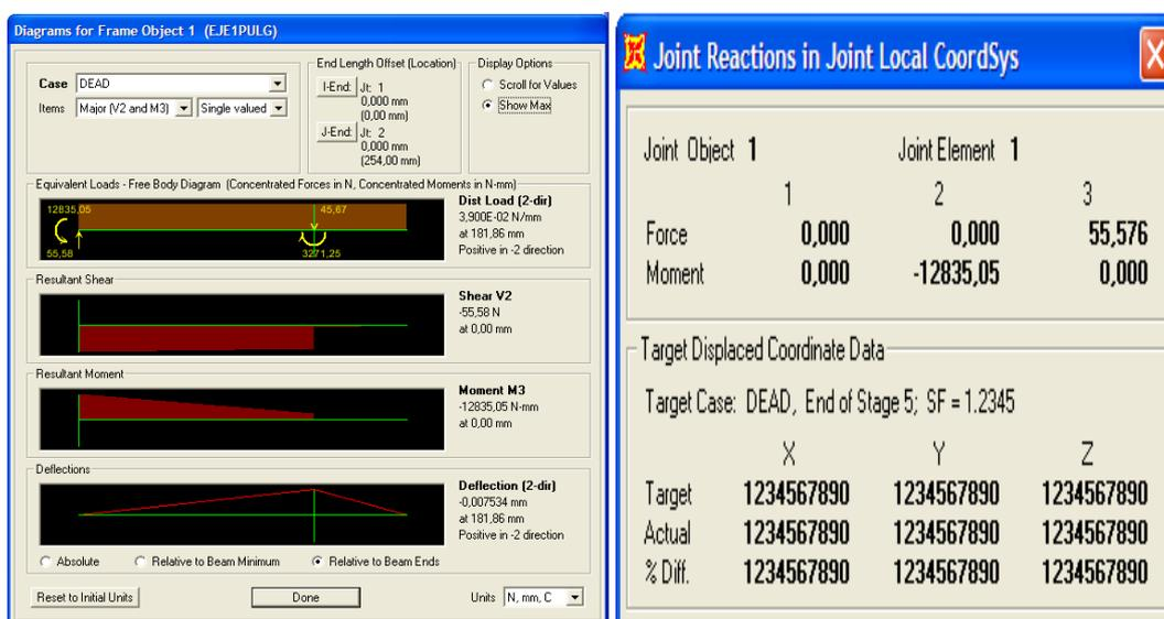
Figura 3.8 Cuadro con valores máximos de reacciones y momentos resultantes en las distancias críticas del eje.
