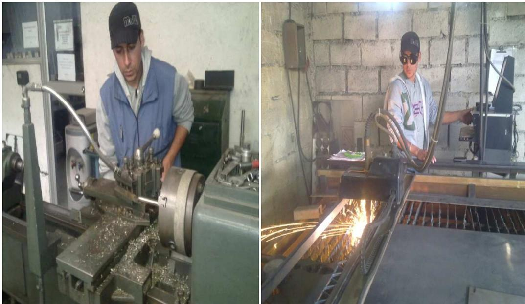
FOTOGRAFIA 2. Fabricación del eje principal y volantes del prototipo.
