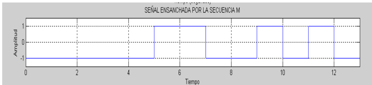
Figura 3.29 Gráfica de la señal ensanchada por secuencia M.
